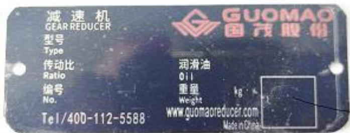
要采购备件或寻求技术支持时。通过铭牌可以了解此款减速机的型号、传动比、编号、售后电话等相关信息。为了便于查询与维护，请勿擅自拆除
